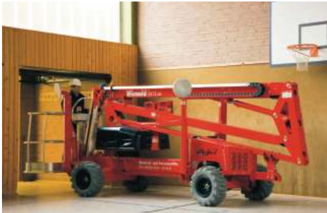
Nur 1,68m breit | Reifen für empfindliche Bodenbeläge (nicht markierend)
